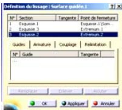
La méthodologie et les options de lissage en retrait
