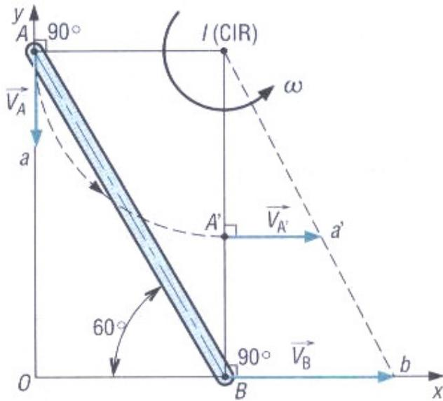
Déterminer graphiquement par la méthode du CIR la vitesse en B sachant que celle-ci appartient au plan du sol (direction x).
